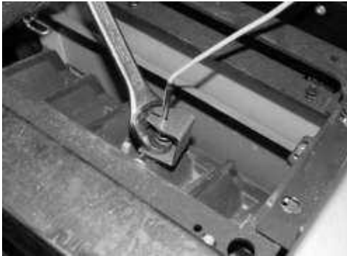
Obrázok 3 – odstránenie krídlovej matice
