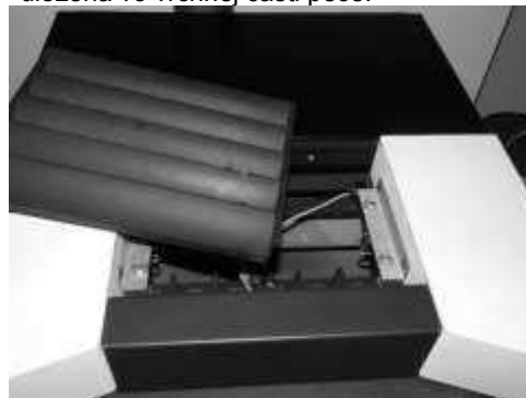
Obrázok 2 – odstránenie konvekčnej mriežky
