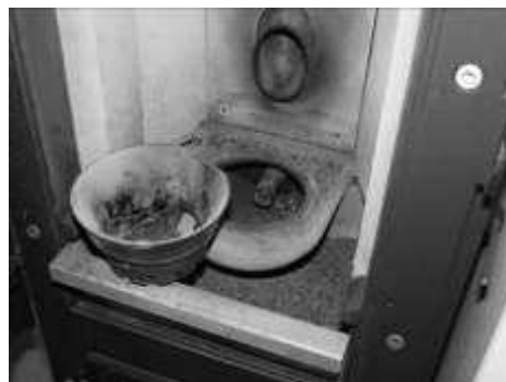
1 – čistenie ohniskovej misky a okolitého priestoru
