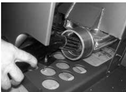
Obrázok 9 – čistenie púzdra ventilátora spalín
