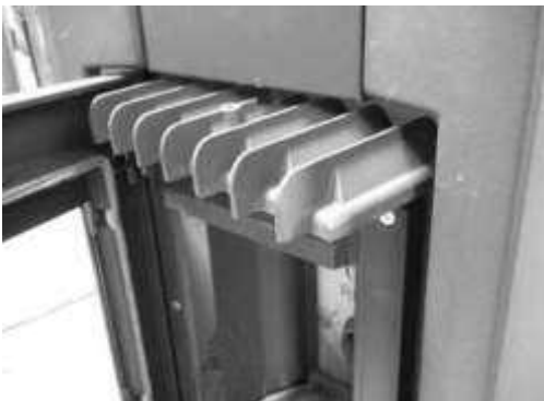
Obrázok 5 – odstránenie predného krytu (deflektora)
