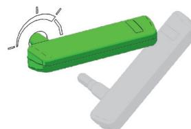
Otáčajte imbusovým kľúčom proti smeru hodinových ručičiek, kým nie je proti rýske na bočnom paneli (asi 45 °). Teraz ste v polohe vykurovania.
