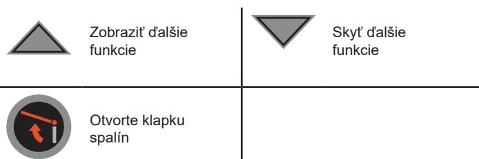
Otvorte klapku spalín a pred otvorením dverí spaľovacej komory počkajte asi 3 sekundy, aby sa spaliny nasmerovali do komínového telesa.
