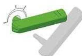
Otačajte imbusovým kľúčom proti smeru hodinových ručičiek, kým nie je proti ryske na bočnom paneli (asi 45 °). Teraz ste v polohe vykurovania.
